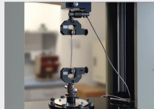
Zwick Universalprüfmaschine: Neben dynamischen Druck- und Zugversuchen können durch Einsatz spezifischer Werkzeuge verschiedene mechanische Werkstoffeigenschaften ermittelt werden wie Reibungskoeffizient, Stauchwiderstände und 4-Punkt-Biegesteifigkeit.
