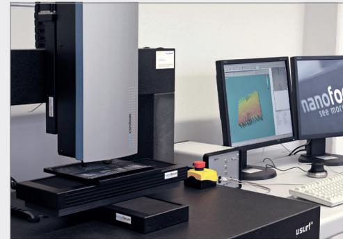
3D-Oberflächenmesssystem (µsurf custom/NanoFocus): Das berührungslos arbeitende µsurf custom erfasst exakt dreidimensionale Strukturen und komplexe Geometrien im Mikro- und Nanometerbereich.
